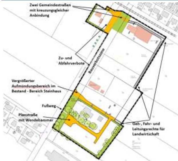
Abb. 19 Verkehrsflächen im Plangebiet
